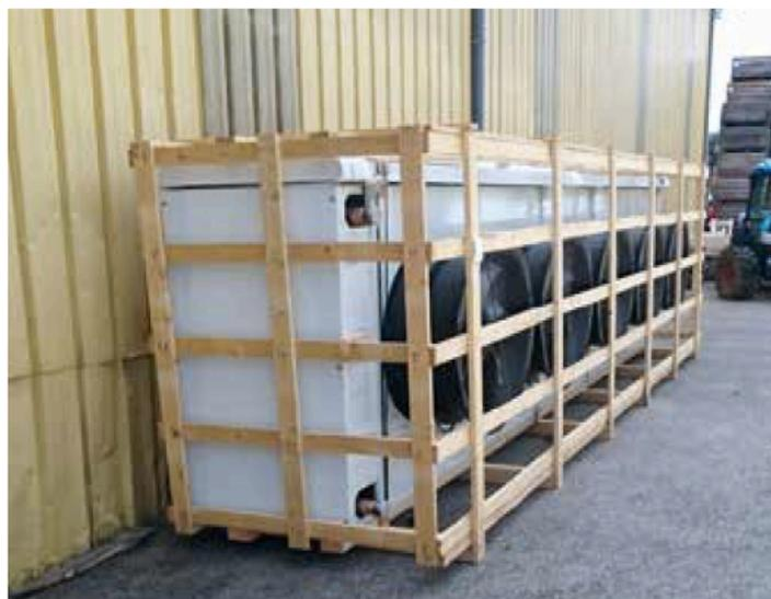
Chantier qui vient d'être mis en service, Brun Conditionnement, évaporateur HDCOLD, centrale au NH3/glycol prévue pour 5 000 t de stockage.
