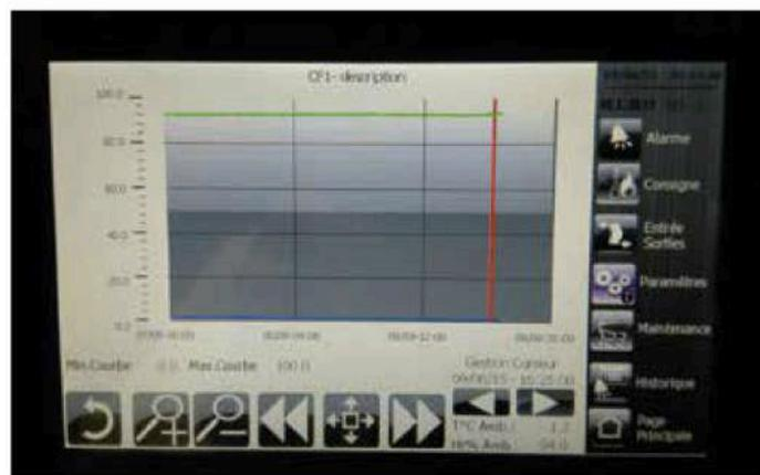
**L'HD Cold permet de maintenir une température de 1°C (en bleu) et une hygrométrie de 94 % (en vert) constantes pendant 24 heures.**
